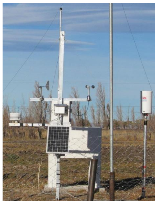
62 Figura 3. Estación meteorológica automática NIMBUS, 63 instalada en la localidad de Sarmiento, Chubut.
