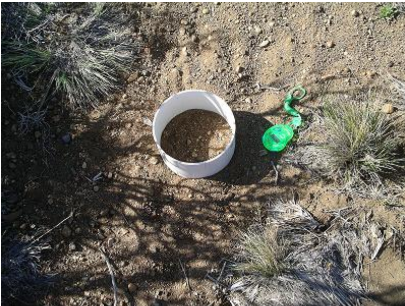
Figuras N° 2-5. Material grueso en la superficie del suelo. Infiltrómetro de anillo simple instalado previo a la lectura.
